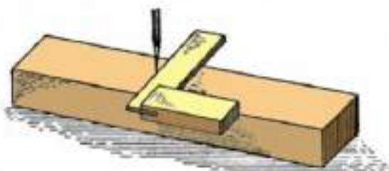
Сурет -1.63 Анлажды бұрыштық көмегімен белгі линиясын жүргізу
