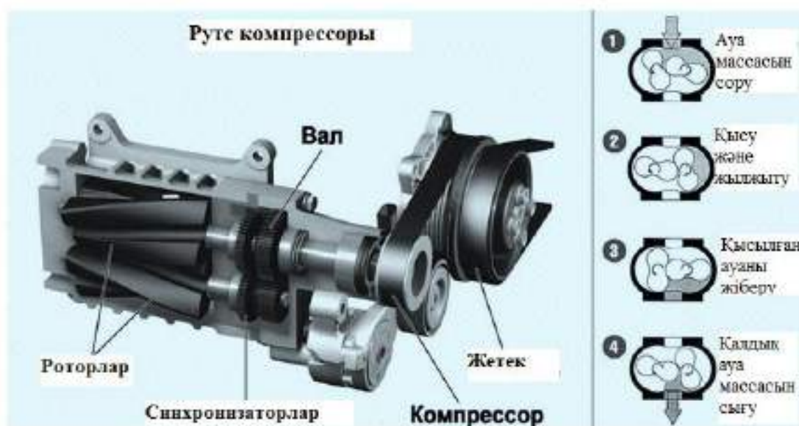
Сурет 2.4-Ruts компрессорының жұмыс принципі
